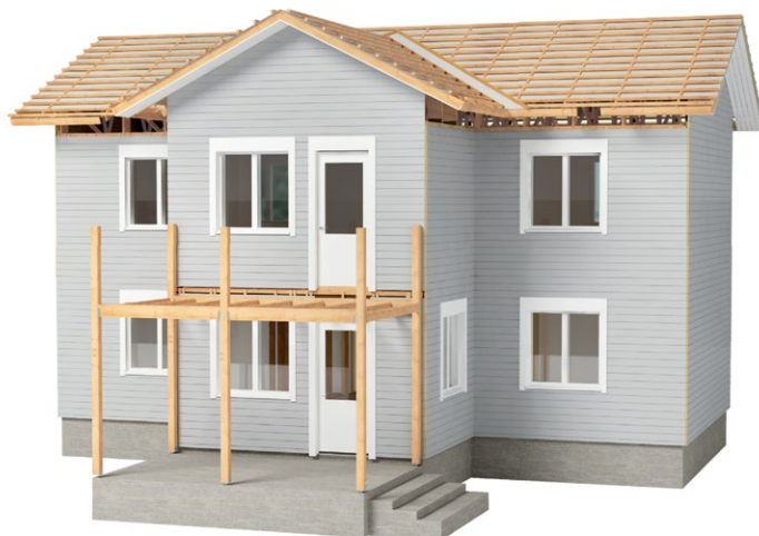
Talopaketti sateelta suojaan -asennuksella
